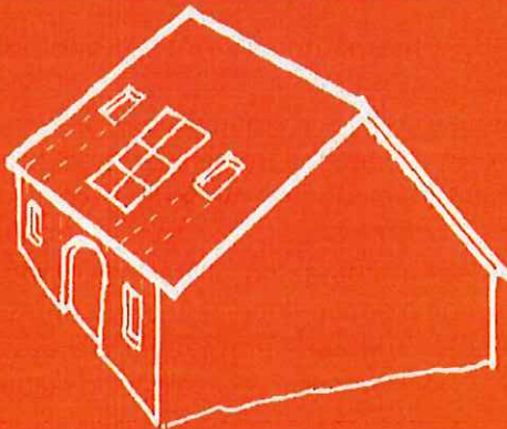
Les fenêtres de toit et panneaux solaires sont ordonnancés dans un projet d'aménagement global des combles, et reprennent les alignements des ouvertures en façades.
